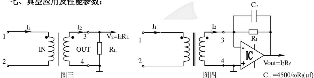
1. 电阻法直接获得采样电压时(如图三), 性能参数见表一;
